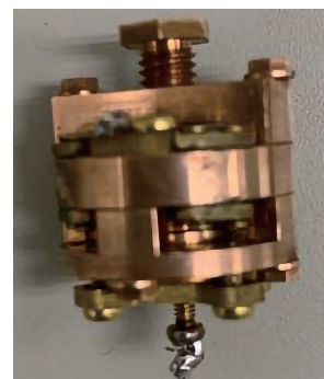
図1：自作のキャパシタンス式膨張計。
