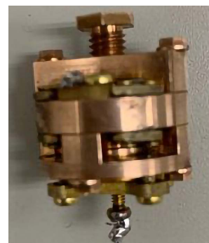
図1：自作のキャパシタンス式膨張計。
